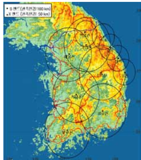
[그림 2-3] 전국 강우레이더 설치 위치도 (출처 : 국토교통부 보도자료)
