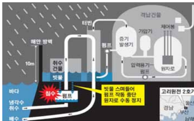
[사진 3-6] 고리원전 2호기 취수건물 침수원인을 보여주는 자료그림 (조선비즈, 2014.8.27)
